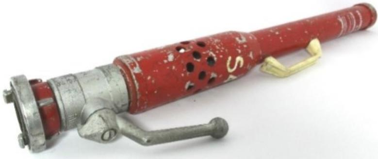
La función de este pitón es lanzar la espuma a distancia. Para preparar la espuma que sale por el pitón, es necesario conectar la manguera a un pre-mezclador de espuma, por el cual se inyecta un polvo al agua que permite crear una mezcla que al contacto con el aire se convierte en espuma.
