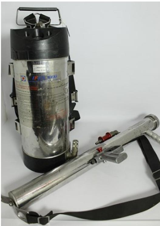
Está compuesta por dos partes: una pistola alargada con una capacidad de disparar un litro de agua a 400 km/h y una mochila cilíndrica con un estanque de agua de 13 litros y un tanque de aire comprimido que da la fuerza a la descarga del agua.
